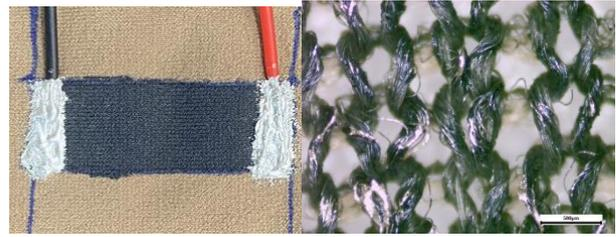
Fig. 1. (a) 맥신 기반 직물 센서 사진
